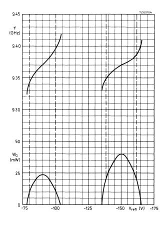
TYPICAL CURVES OF POWER AND FREOUENCY AGAINST REFLECTOR VOLTAGE
