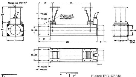
Waveguide taper 55342
