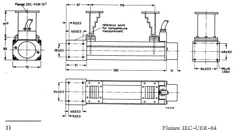
Waveguide taper 55342
